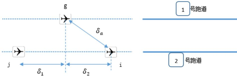
图 D-1 相关平行进近示意图
