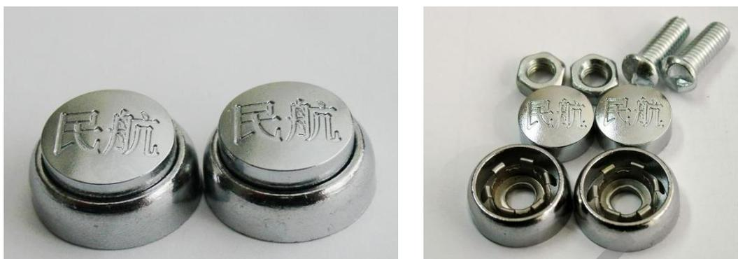
注：固封螺丝，是一种专用固定机动车号牌的固封装置，每副号牌至少使用两个“固封螺丝”固定。主要由螺栓、螺母、固封底座和固封扣盖组成，具有防拆卸和防松脱功能。定制的固封螺丝固封扣盖上印有民航字体。
