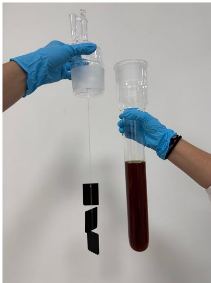
图 1 弹性体相容性试验（72 h）浸泡装置
