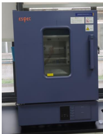
图 4 弹性体相容性试验（1800 h）加热装置
