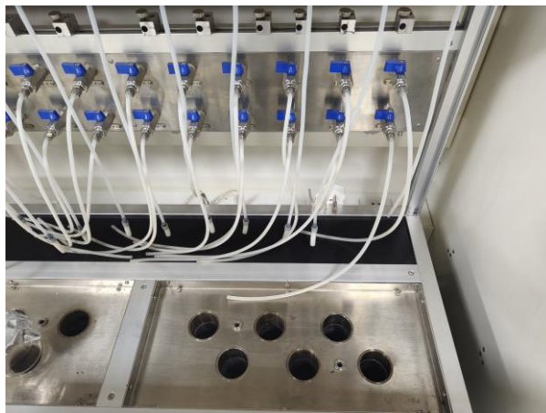
图 2 弹性体相容性试验（72 h）加热装置
