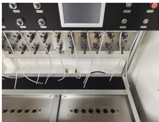
图 6 弹性体相容性试验（试验至失效）加热装置
