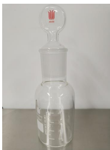
图 3 弹性体相容性试验（1800 h）浸泡装置
