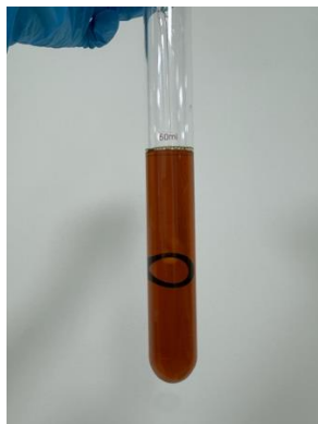
图 5 弹性体相容性试验（试验至失效）浸泡装置
