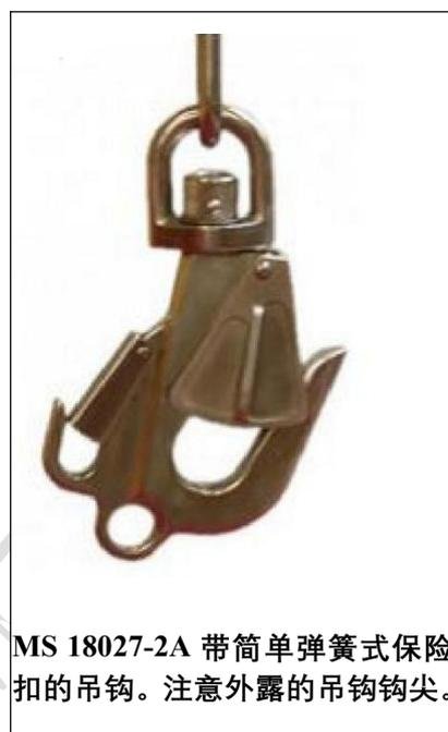
MS 18027-2A 带简单弹簧式保险扣的吊钩。注意外露的吊钩钩尖。
