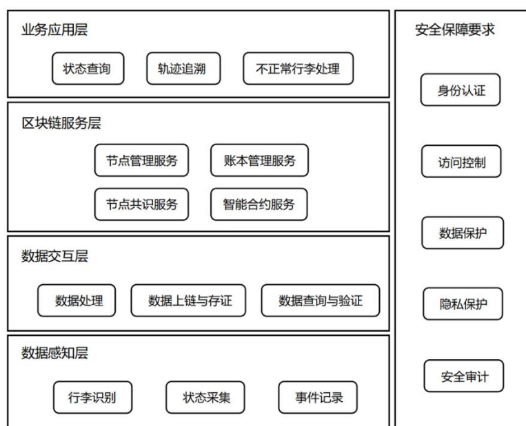
图1 民航旅客行李全流程跟踪技术架构
