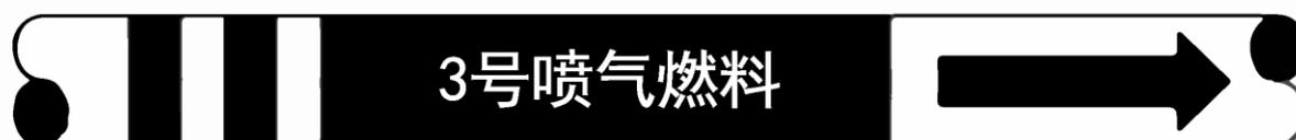
图3 带流向标识的输油管道标识样例
