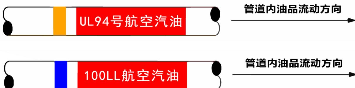
图2 航空活塞式发动机燃料输油管道标识样例
