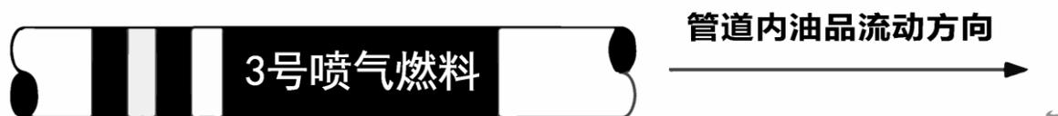
图1 喷气燃料输油管道标识样例
