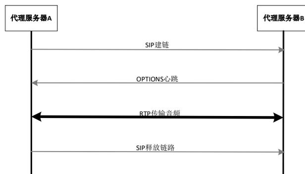
图1 VoIP 有线通信基础流程
