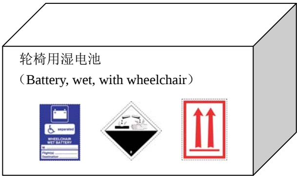
图B. 3 非防漏型电动轮椅、助行器的电池包装外部标记和标签
