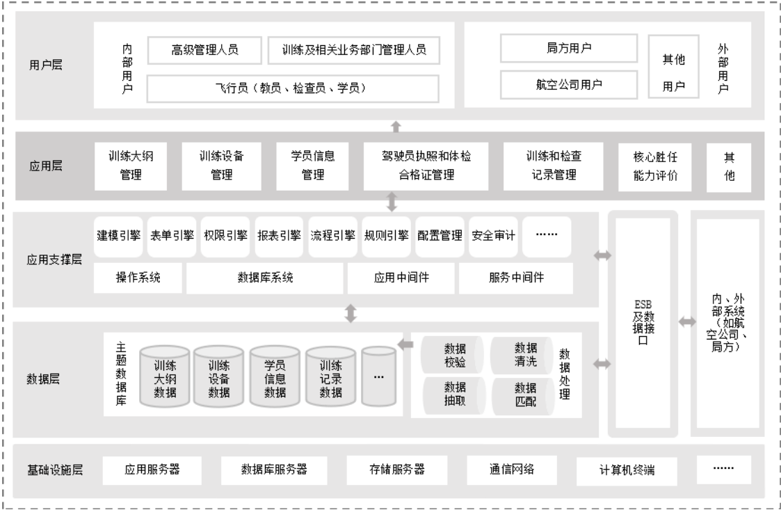
图1 驾驶员学校基于计算机的飞行训练记录系统框架
