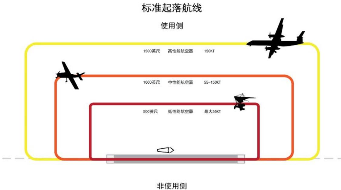
图2 机场标准起落航线的水平和垂直间隔
