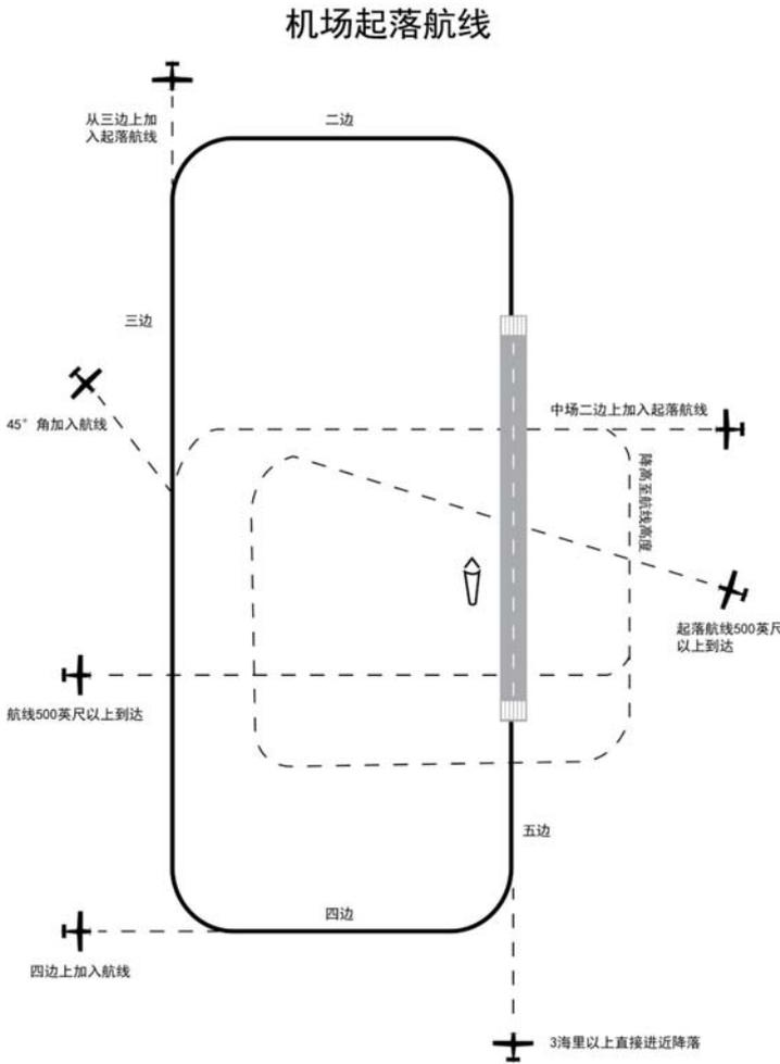
图 3 机场标准起落航线，显示进场和加入程序
