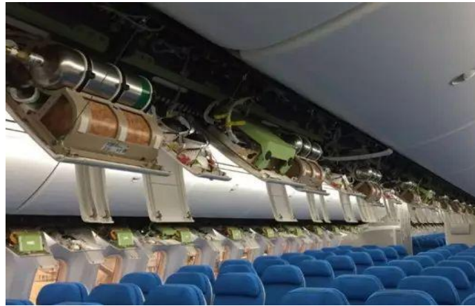
图 15 B787 分散型气体式氧气系统
