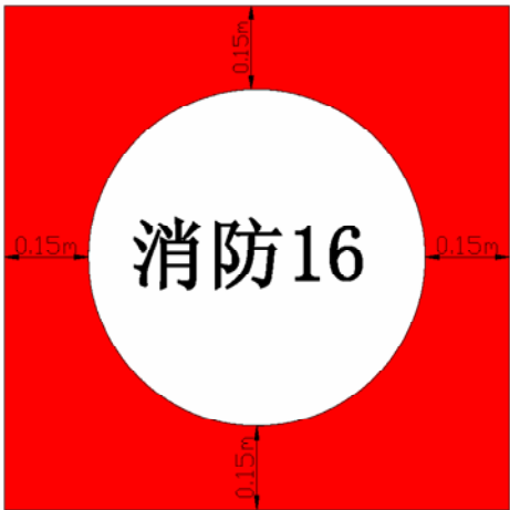
图 22-1 机坪上消防井标志
