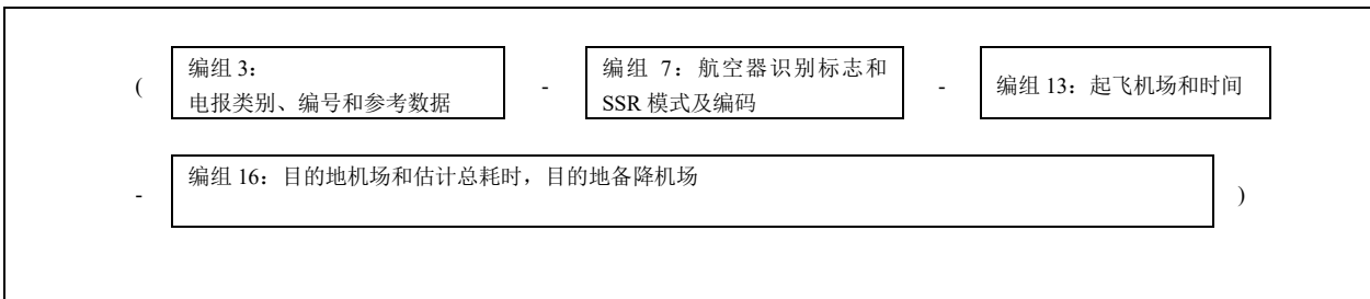
图32 管制协调接受报报文构成
