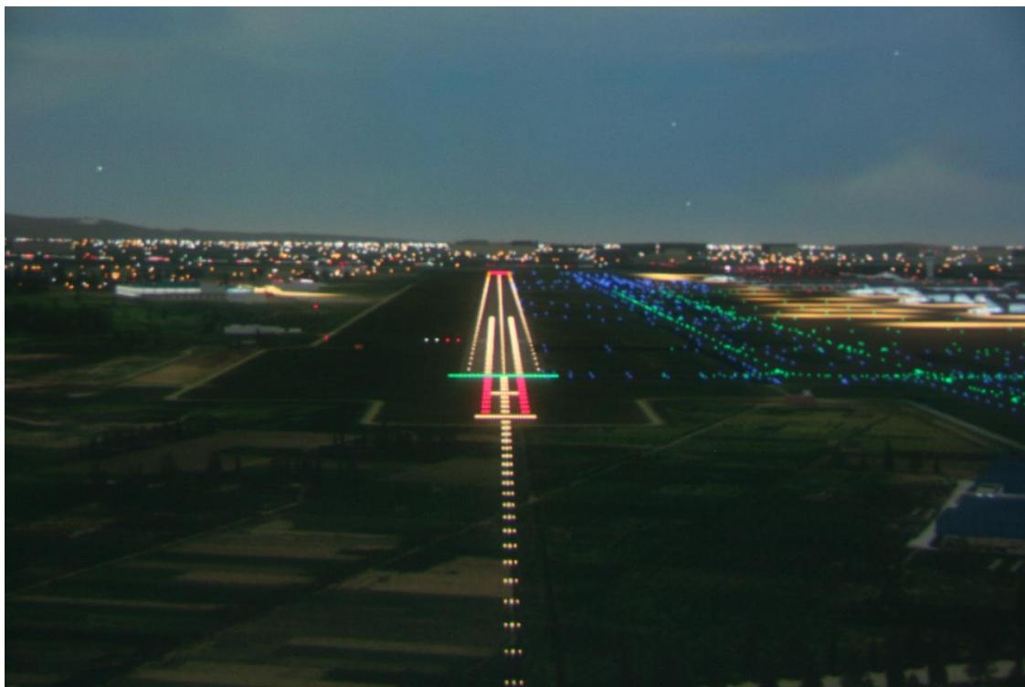
跑道中线灯系统(RCLS): 跑道中线灯沿跑道中线布局 25 英尺(7.5 米), 50 英尺(15 米) 或 100 英尺(30 米)。
