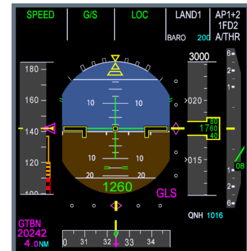
GLS 工作原理及飞机仪表显示
