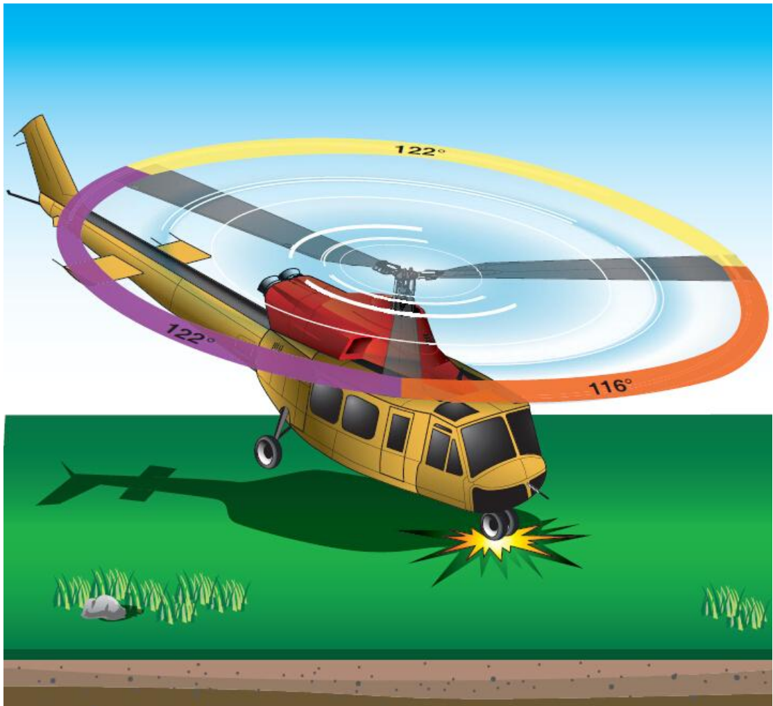
图 3 桨叶间的相位发生改变破坏了平衡
