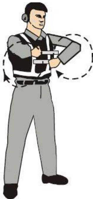
R. 往后倒退时转弯（机尾向右）：左臂向下指，右臂上举过头部，然后放下至前面水平位置，右臂重复运动。
