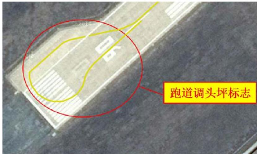
**说明:**跑道调头坪标志为连续实线，为驾驶员提供连续的引导，使飞机能够完成180°转弯和对准跑道中线。在不大于设计最大机型的情况下，驾驶舱位于标志线上方滑行时所有机轮和掉头坪边缘有足够间距。
