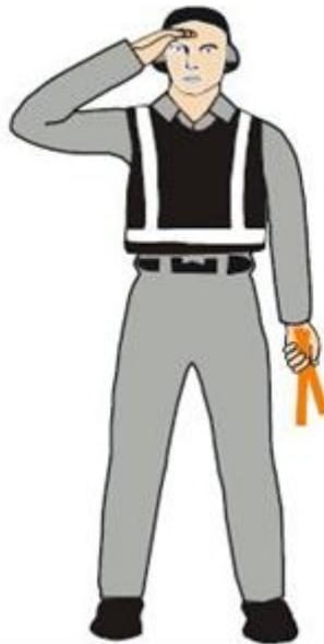
W. 请勿触摸操纵器（技术/保养通信信号）：右手伸直举过头部，手握拳或水平方向握住指挥棒，左臂放在体侧膝部。
