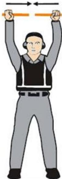
**L. 取轮挡:** 两臂和指挥棒完全伸出, 举至头部上方, 向外“戳”动指挥棒。未经飞行机组人员批准, 不得取出轮挡。
