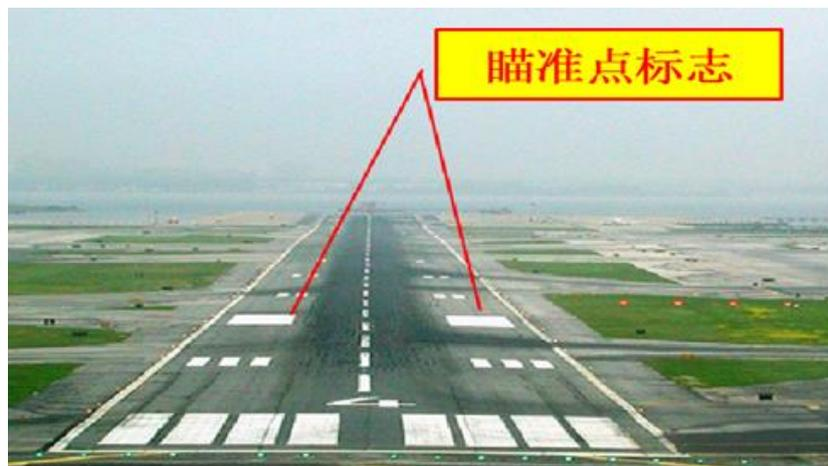
**说明:**瞄准点标志通常设置在跑道的每个进近端，由两条明显的粗的白色条块组成，为驾驶员操纵飞机着陆提供目视参考。
