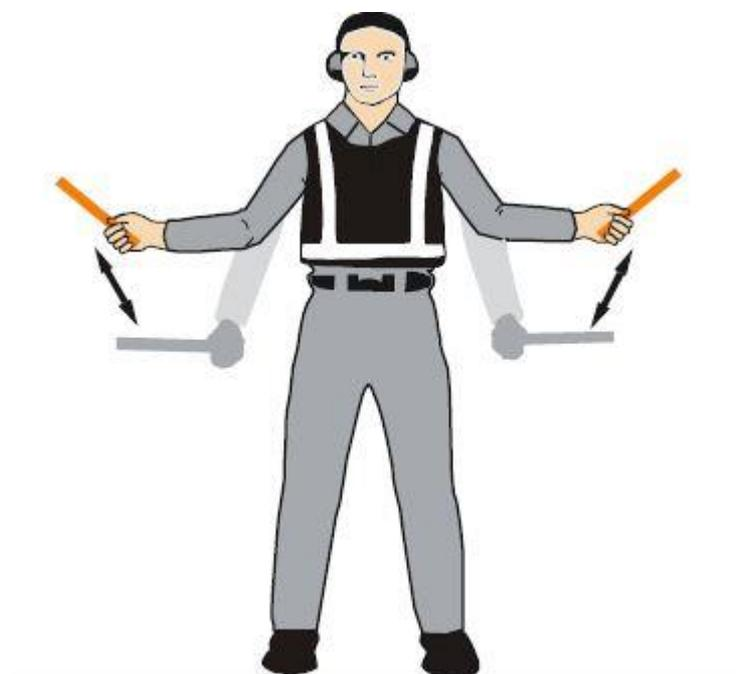
P. 减低信号所指一边的一台（或两台）：发动机的转速：两臂向下，手心向地，然后上下挥动右手或左手，挥动右手表示左边发动机要减速，挥动左手表示右边发动机要减速。
