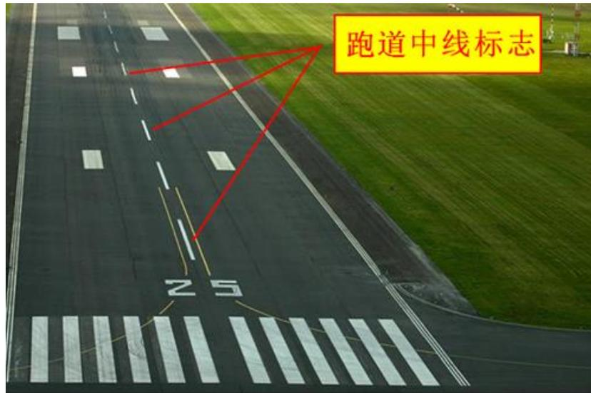
**说明:**跑道中线标志用于标明跑道中心线，由均匀隔开的白色线段和间隙组成。
