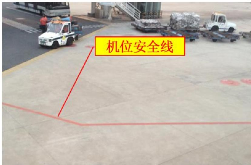
**说明：**机坪上根据航空器停放布局和地面设施的需要设置有机位安全线。飞机入位时，机位安全线所包括的范围应当没有障碍物（除引导飞机入位的机务和个别轮档、锥筒外）。
