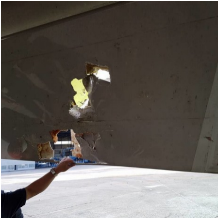
图 2 机翼下表面损伤
