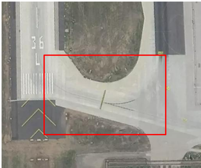
图 5.4 某跑道入口滑行道的布置
