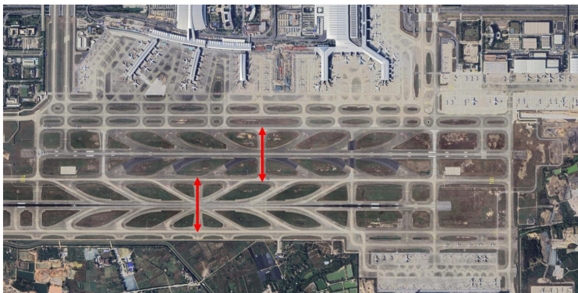
图 7.1-2 B 机场穿越道位于跑道中部的“高能量区”
