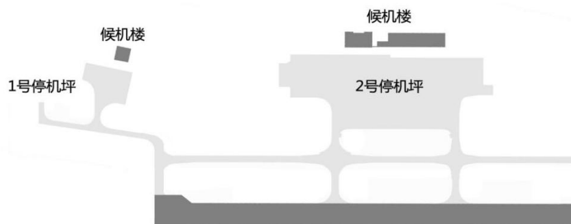
图 8.2 避免平行滑行道延伸的设计示例
