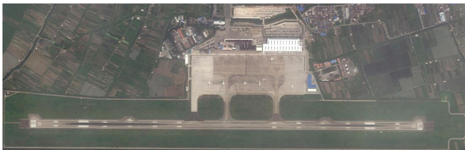
图 9.2 机坪直通跑道的构型
