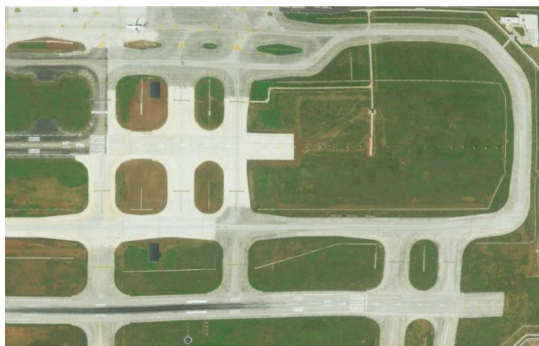
图 13.1-2 某机场为缩短绕滑距离跑道入口内移示意图
