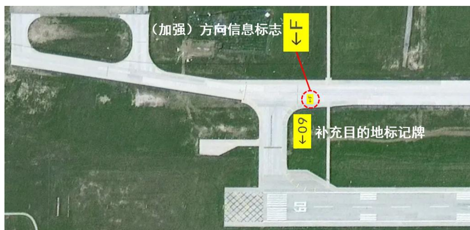
图 8.3-1 强化主运行方向上目视引导方案 1 示意图
