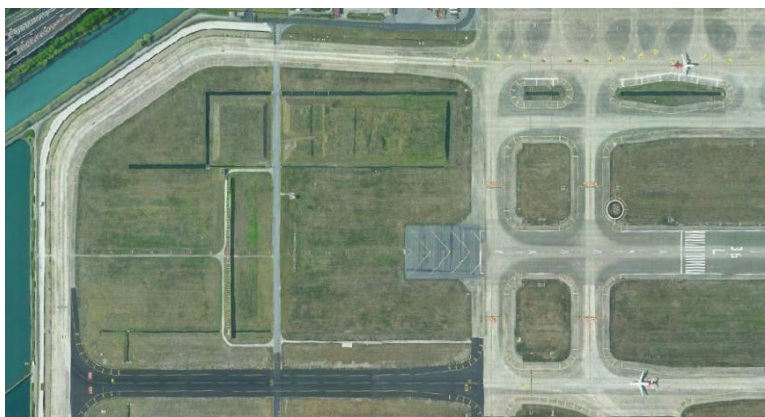
图 13.1-1 某机场绕行滑行道设置目视遮蔽屏示意图
