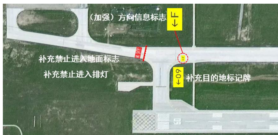
图 8.3-4 设置禁止进入排灯、禁止进入标志示意图
