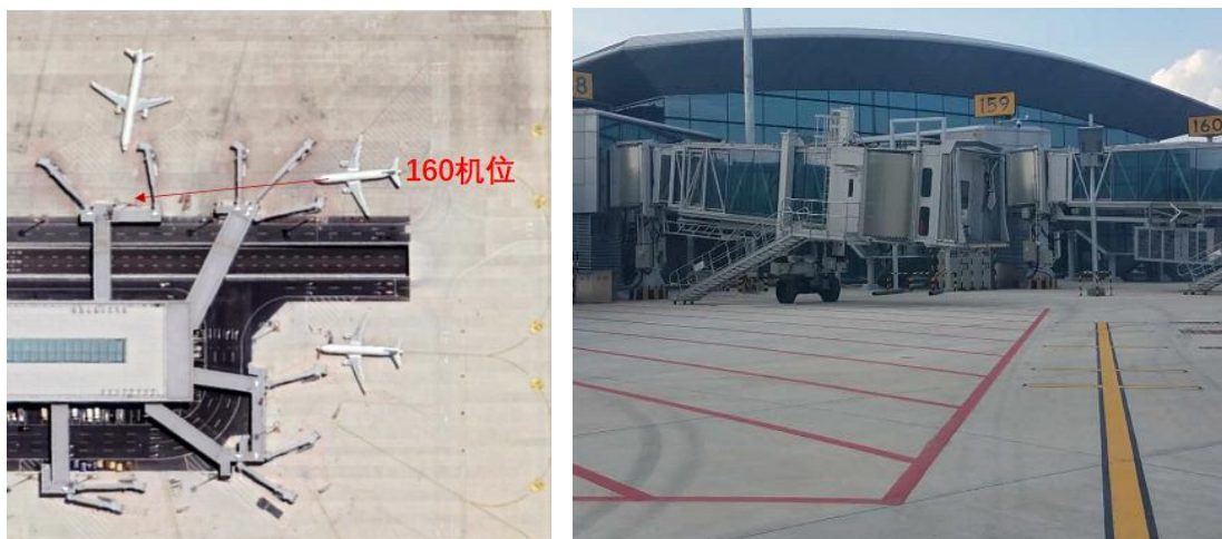
图 11.2-1 某机场 160 号机位标记牌无合理位置平面示意图
