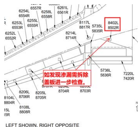
图 2 大翼上部拆卸盖板示意图
