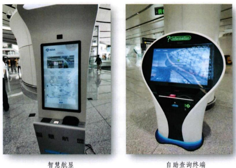
图 4-3 大兴机场智慧航显及查询终端
