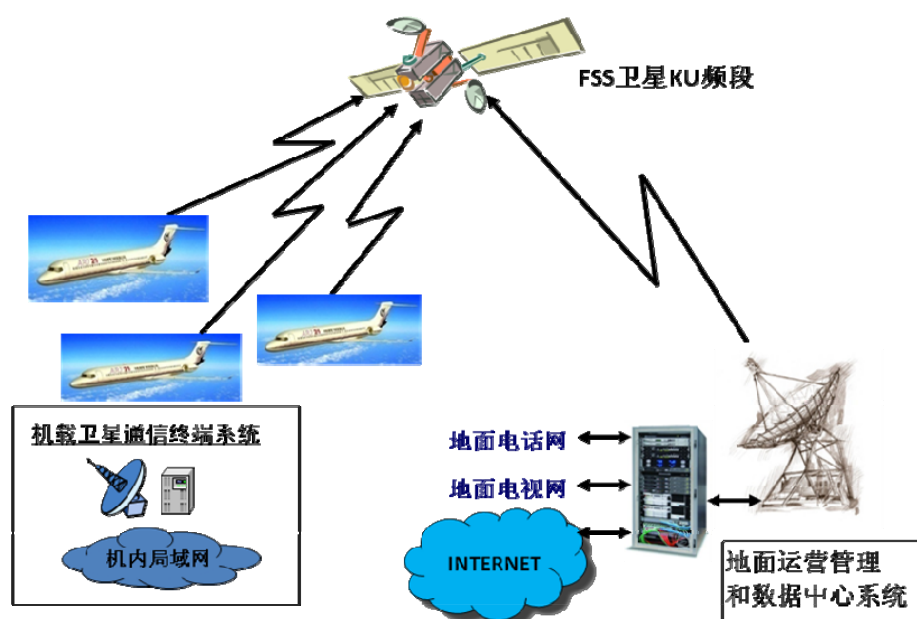
附图6 机载卫星宽带通信系统组成结构示意图
