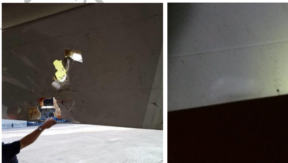
图2 机翼下表面损伤
