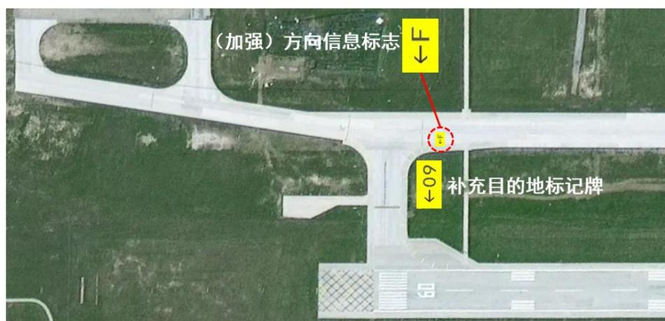
图 8.3-1 强化主运行方向上目视引导方案 1 示意图
