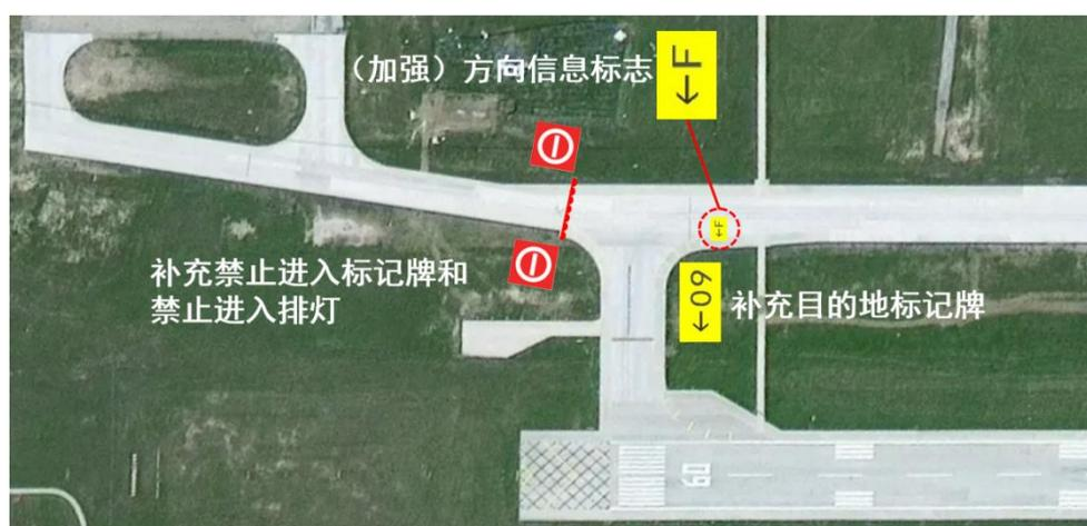
图 8.3-3 设置禁止进入标记牌、禁止进入排灯示意图
