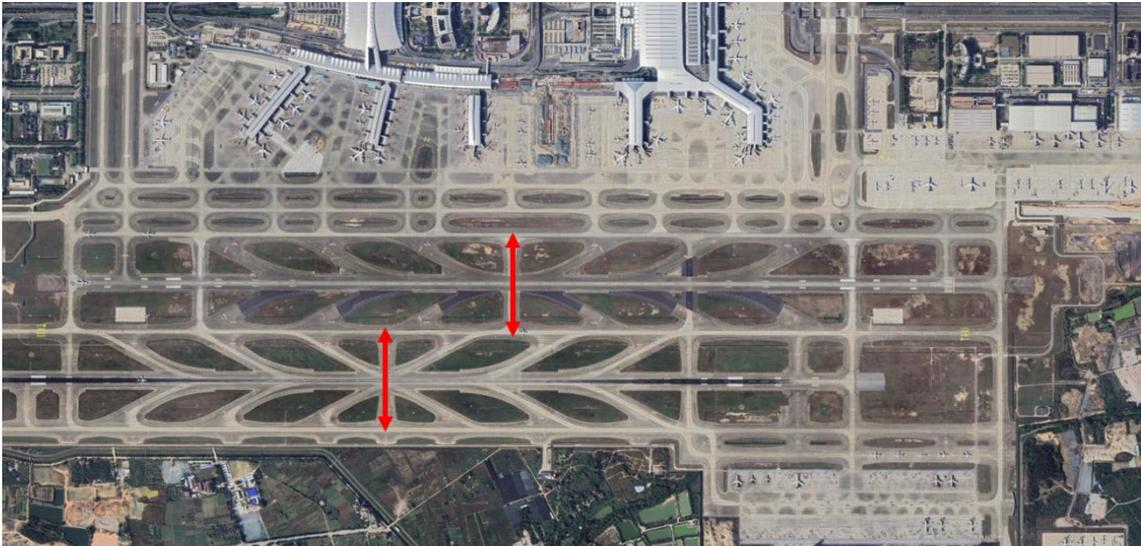
图 7.1-2 B 机场穿越道位于跑道中部的“高能量区”
