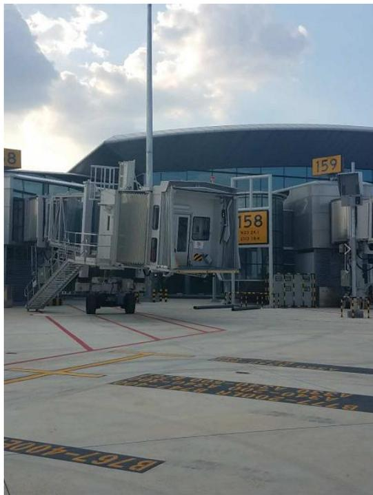
图 11.2-2 某机场 158 号机位标记牌被遮挡示意图
