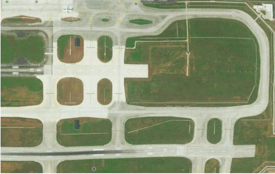
图 13.1-2 B 机场为缩短绕滑距离跑道入口内移示意图
