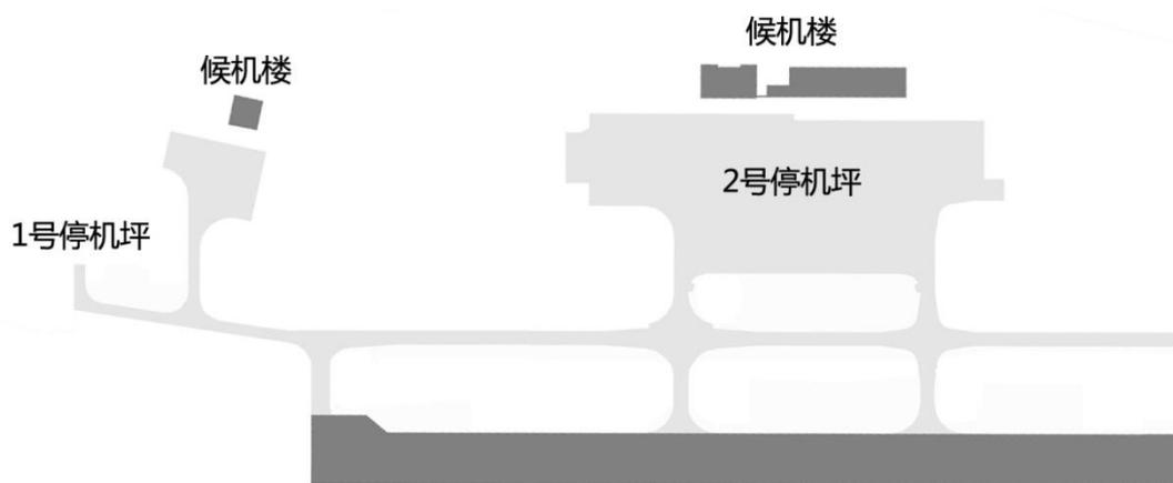
图 8.1-2 平滑在跑道端以外继续延伸示例 2
