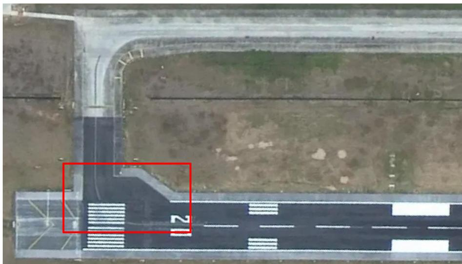
图 2.1-1 跑道端新建端联络道，原掉头坪增补面仍存在，而有关标志施划不全的示意图
