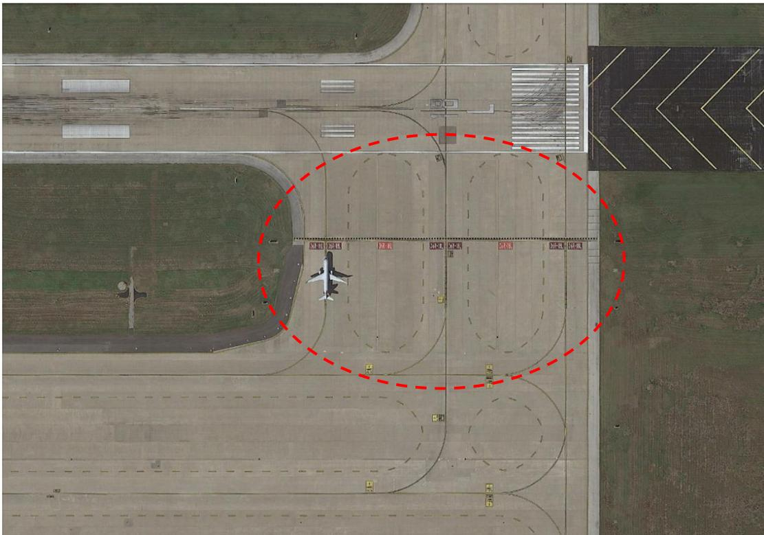
注：入口滑行道间无土面区分割，跑道警戒灯、标记牌等目视助航设施无法设置。
