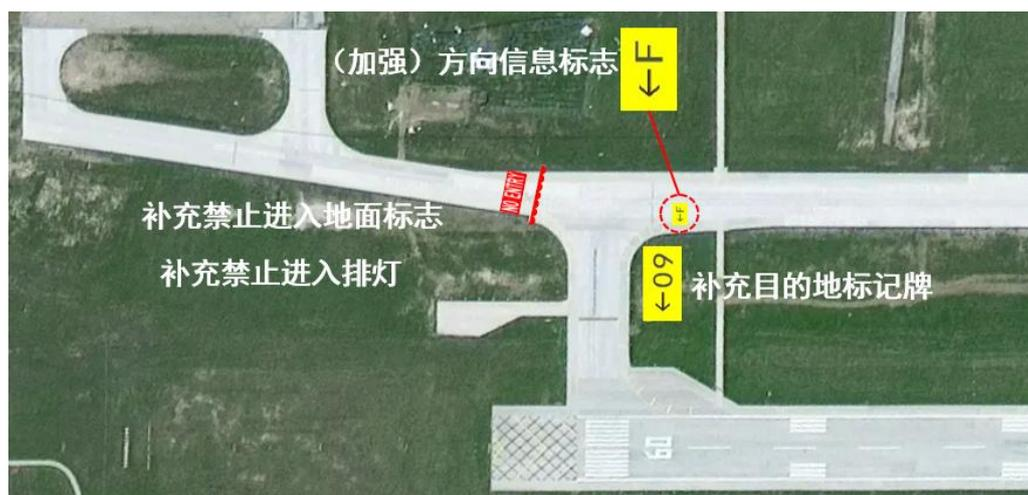
图 8.3-4 设置禁止进入排灯、禁止进入标志示意图
