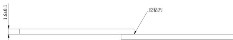
a) 剪切强度试验件（正面）
