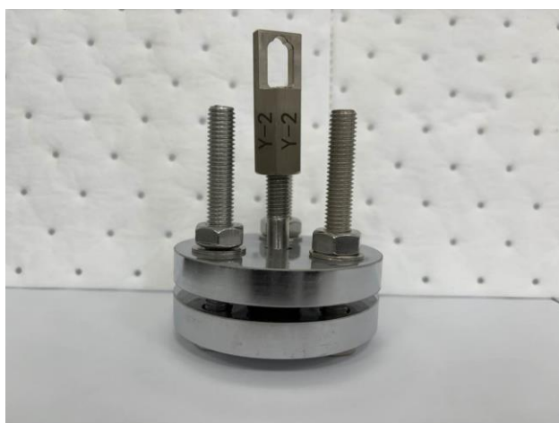
图 2 压缩形变夹具
