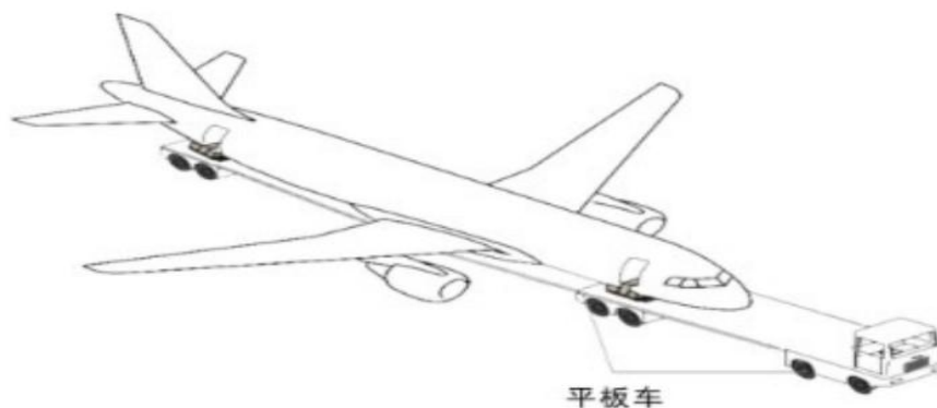
图 5.2.1-2 使用平板车搬移残损航空器
