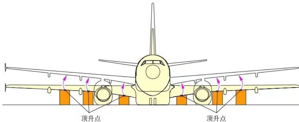
图 6.2.6-3 两侧主起落架折断气囊顶升示意图
