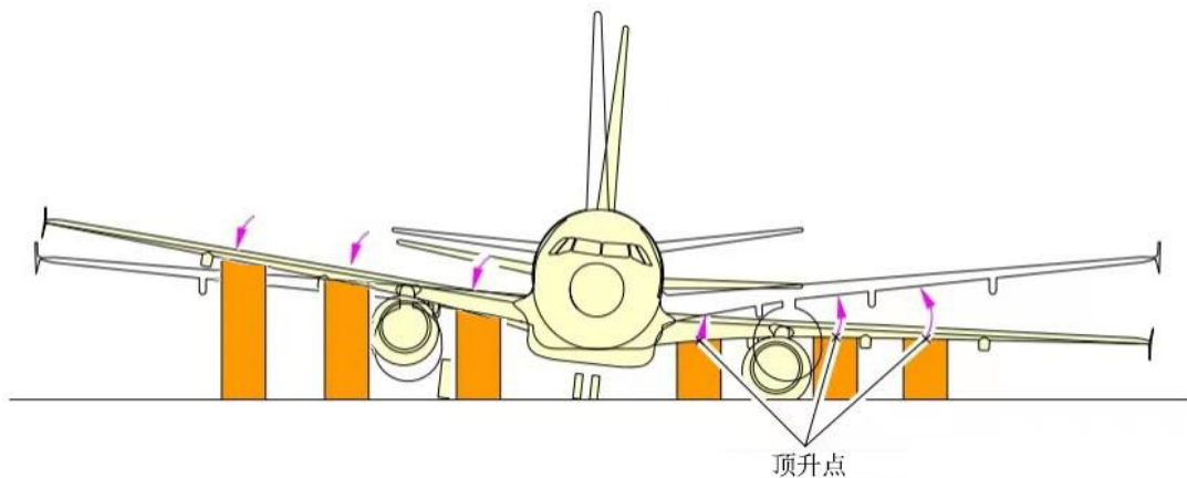
图 6.2.6-2 一侧主起落架折断气囊顶升示意图
