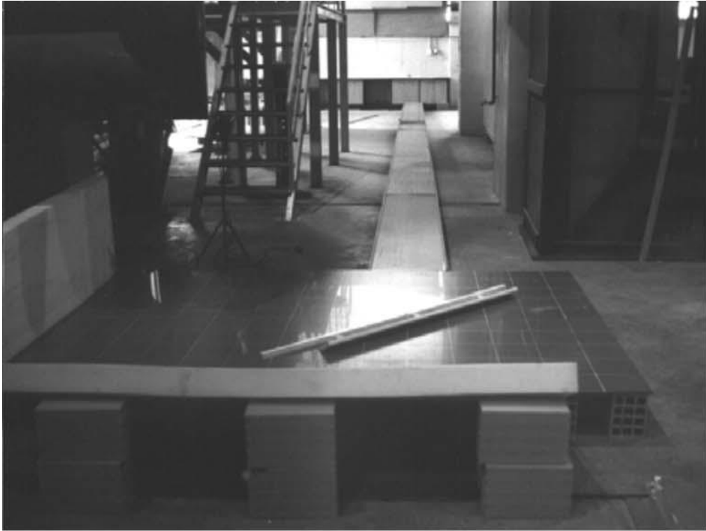
图 2- 19 包括可调节拦护装置的跑道模型
