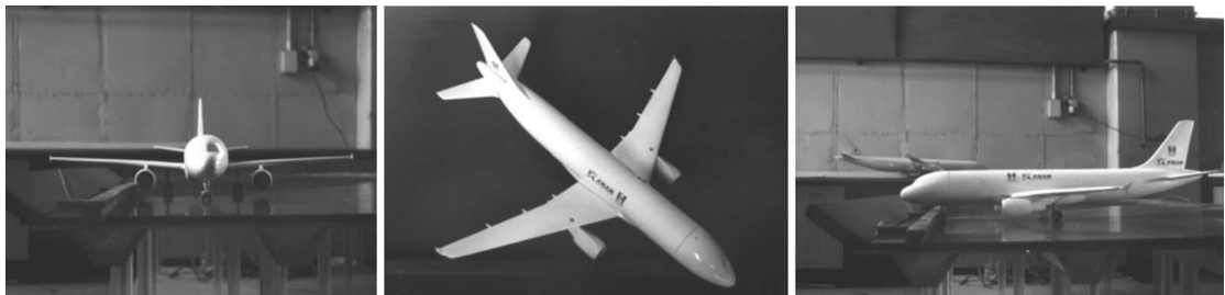
a) 引擎首先撞击 b) 引擎和起落架同时撞击 c) 起落架首先撞击
