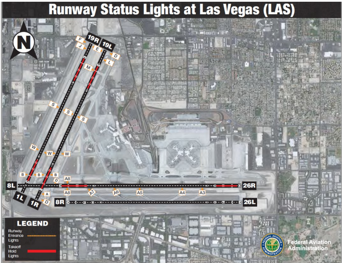
图 6—15 拉斯维加斯国际机场的跑道状态灯安装平面图
