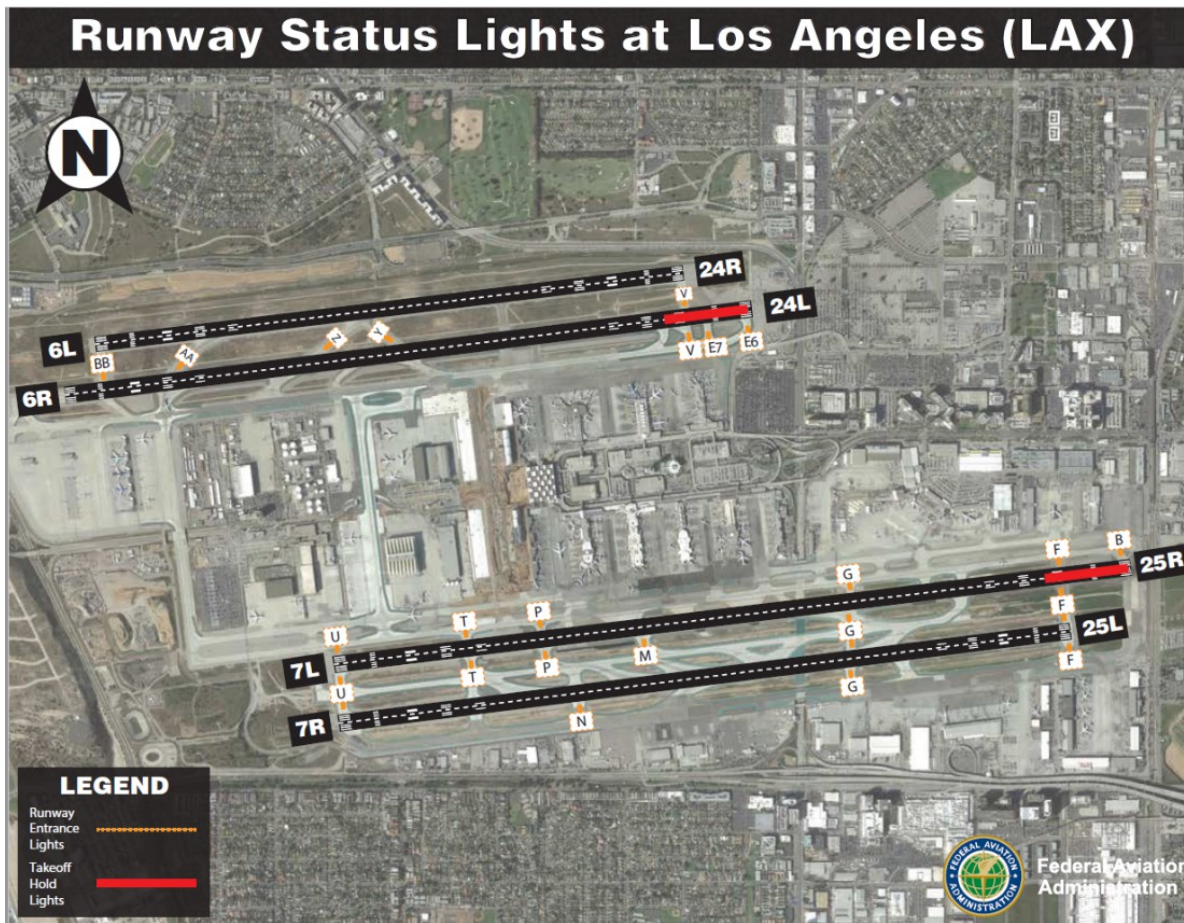
图 6—8 洛杉矶国际机场的跑道状态灯安装平面图
