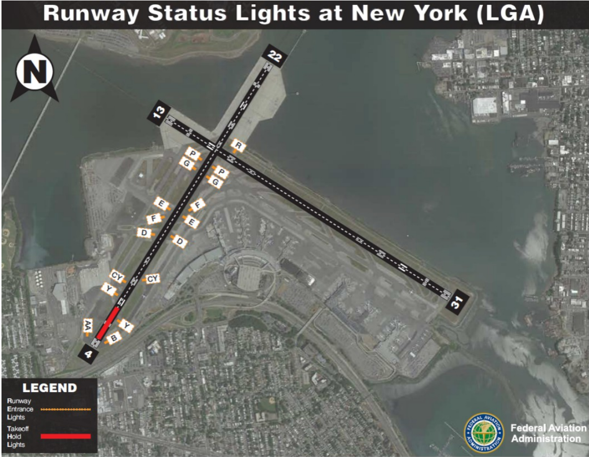
图 6—16 纽约—拉瓜迪亚机场的跑道状态灯安装平面图
