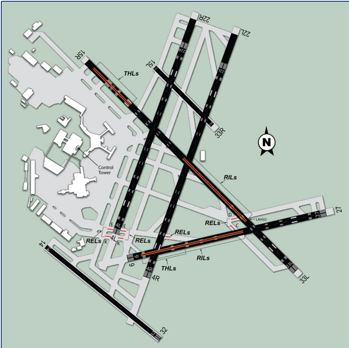
图 6—4 波士顿（BOS）机场的跑道状态灯安装平面图
