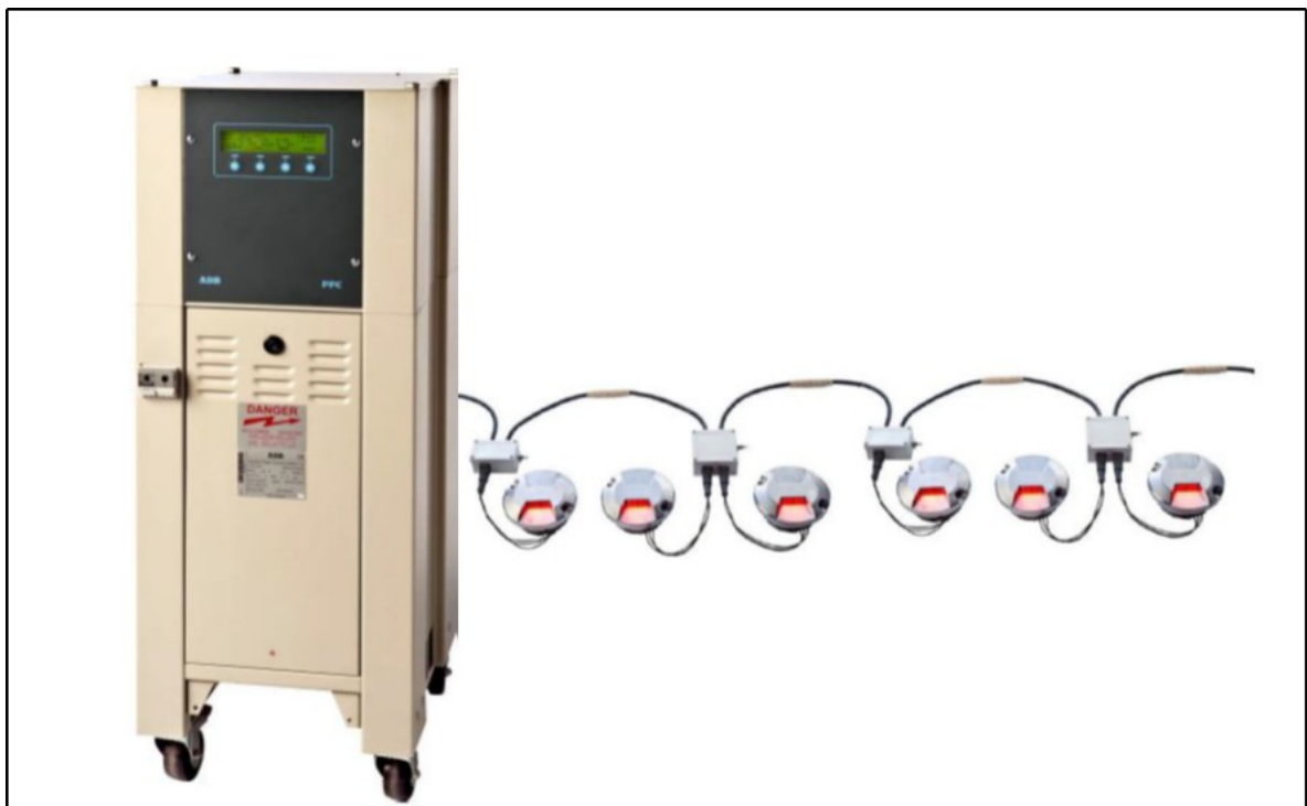
图 7—13 跑道进入灯供电回路实物图
