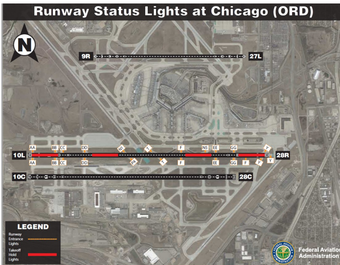
图 6—9 芝加哥国际机场的跑道状态灯安装平面图
