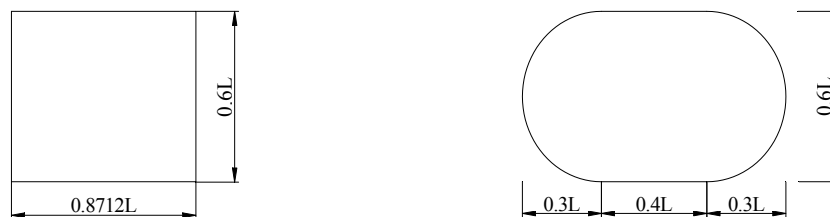
图 4.2-4 矩形轮印和组合型轮印
