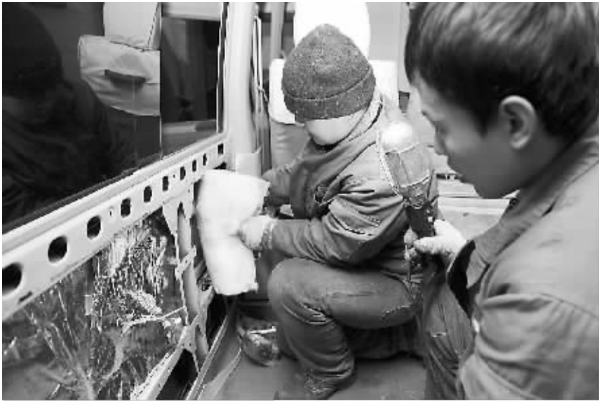
▲工作人员正在连夜改装车辆,为机组车加装保温棉。 李冰川 摄
