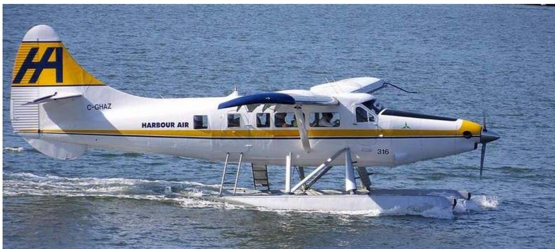
图 1.2-1 浮筒型水上飞机
