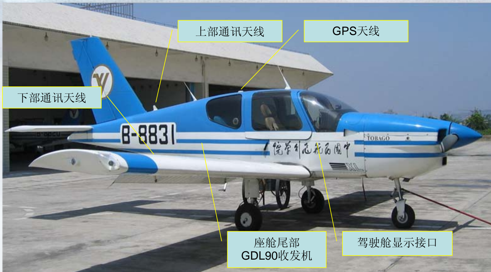
机载设备实物安装图
