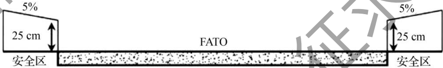
图 5.4.2 因功能要求设置于安全区内物体的限高示意图
